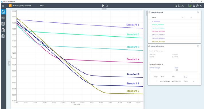
图 3. 使用 Cary 3500 紫外-可见分光光度计系统同时测量 7 个标准溶液得到的基于时间的吸光度测量值
