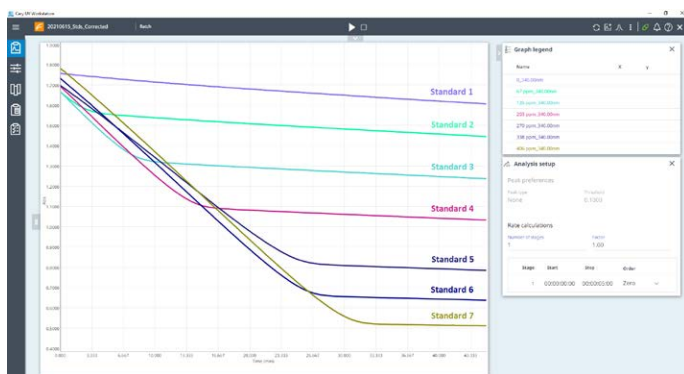
그림 3. Cary 3500 UV-Vis 시스템을 사용하여 동시에 측정, 7가지 표준 용액의 시간에 따른 흡광도 측정.
