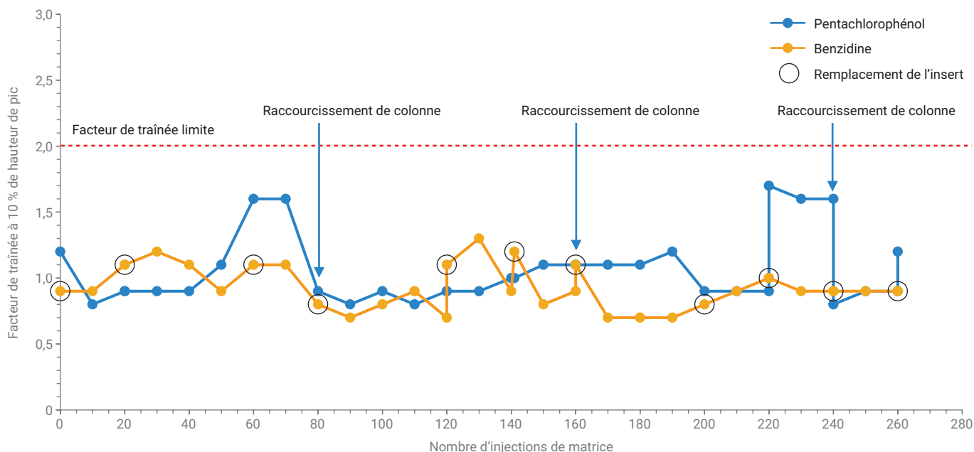
Figure 7. Mesures du facteur de traînée après les remplacements de l'insert et les raccourcissements de colonne pour le pentachlorophénol (en bleu) et la benzidine (orange). La limite de facteur de traînée de la méthode 8270E est indiquée par la ligne de pointillés rouges. Chaque remplacement d'insert est indiqué par un cercle ouvert noir, qui est superposé aux mesures du facteur de traînée de la benzidine pour une visualisation simplifiée des remplacements de l'insert par rapport au numéro d'injection de matrice. Les raccourcissements de la colonne sont indiqués par une flèche pointant vers le numéro d'injection de matrice correspondant.
