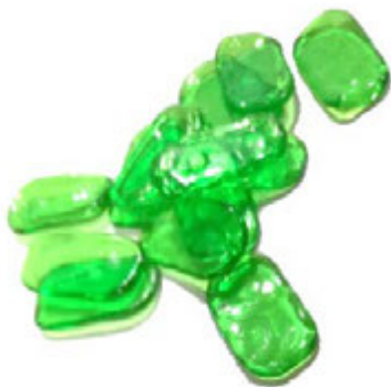
Figura 1. Cápsulas de gel blandas vacías que se han utilizado para preparar los patrones de calibración.
