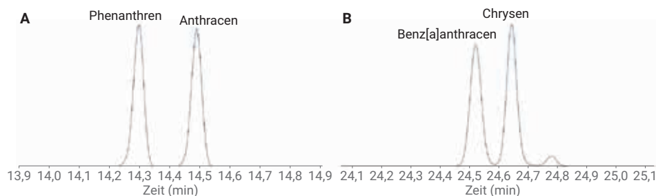
Abbildung 2: Extrahierte Ionenchromatogramme (EIC), die die Basislinienauflösung von Phenanthren und Anthracen (A) und die Auflösung von Benz[a]anthracen und Chrysen (B) nahe der Basislinie illustrieren.
