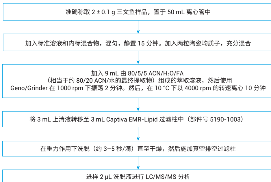
图 1. 使用 Agilent Captiva EMR-Lipid 3 mL 过滤柱（部件号 5190-1003）进行三文鱼样品的萃取和净化
