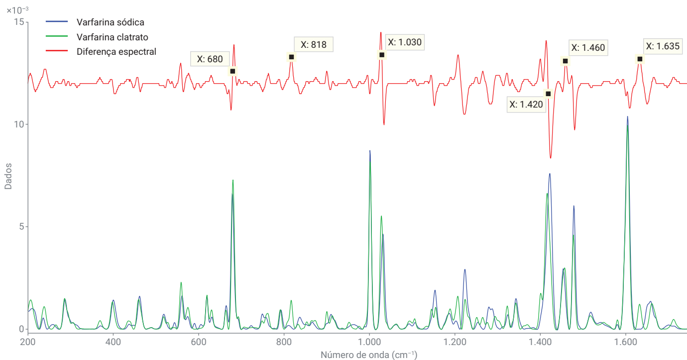
Figura 1. Espectros Raman de transmissão da varfarina sódica e varfarina clatrato de sódio, com diferenças espectrais calculadas.
