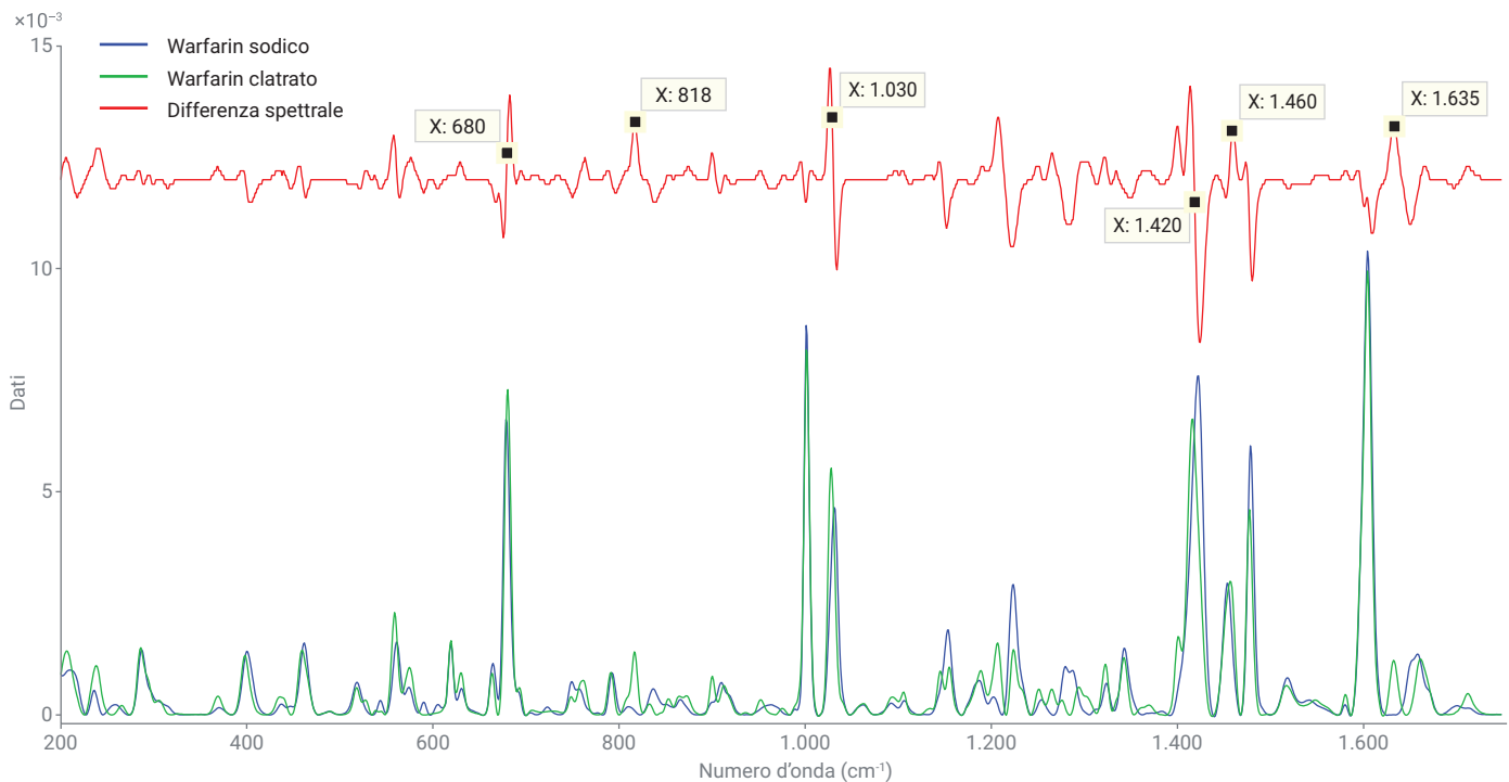
Figura 1. Spettri Raman in trasmissione di Warfarin sodico e Warfarin sodico clatrato, con il calcolo delle differenze spettrali.
