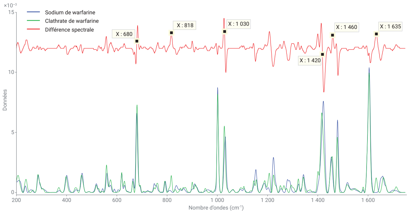
Figure 1. Spectres Raman de transmission du sodium de warfarine et du clathrate de sodium de warfarine, avec différences spectrales calculées.
