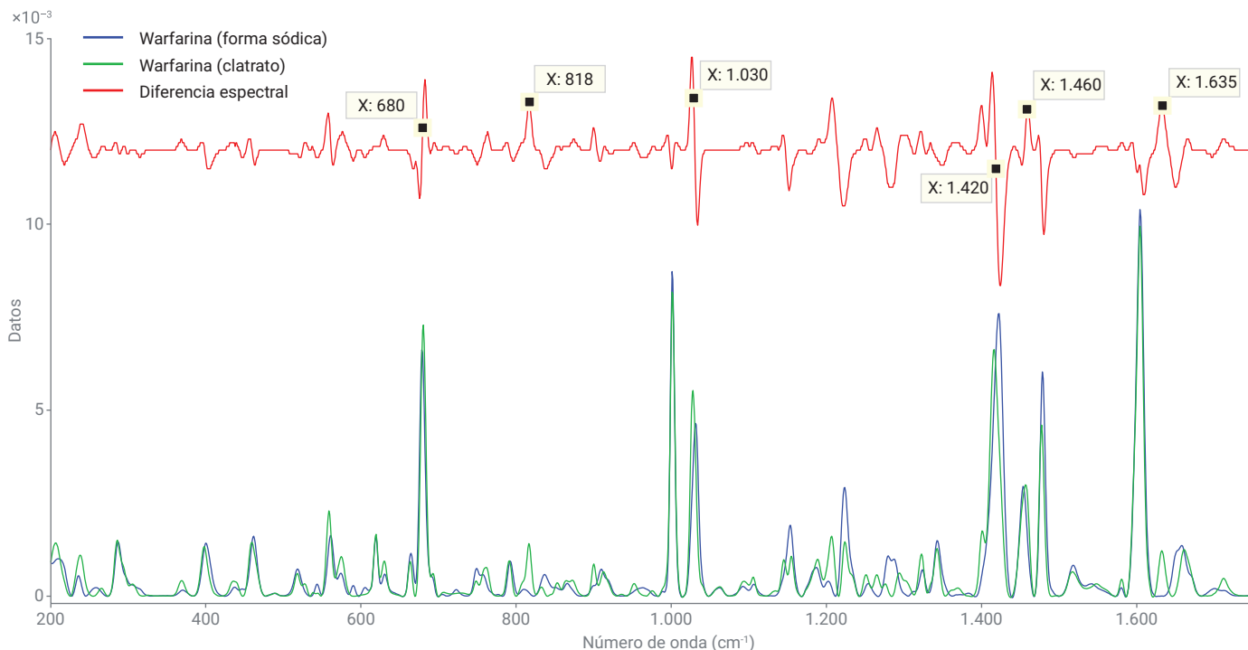
Figura 1. Espectros Raman de transmisión para la forma sódica y el clatrato sódico de la warfarina, incluidas las diferencias espectrales.
