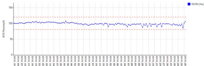
그림 1. Agilent 7900 ICP-MS를 사용하여 10시간 이상 수행된 시료 분석의 ISTD 회수율
