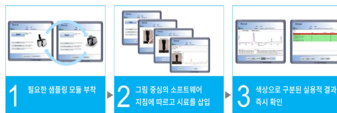
그림 1. FTIR 분석용 MicroLab 소프트웨어는 장착된 샘플링 모듈을 자동으로 인식하고 올바른 파라미터를 적용합니다. 소프트웨어는 안내용 그림을 사용해 사용자에게 분석 워크플로우를 단계별로 안내합니다. 데이터 수집 후 바로 보고되는 색상 코드화된 결과가 데이터 검토를 빠르고 직관적으로 만들어 줍니다.
