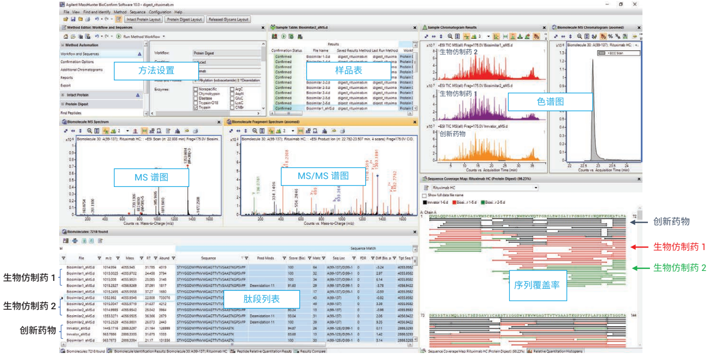
图 2. Agilent MassHunter BioConfirm 10.0 软件的肽谱分析屏幕截图
