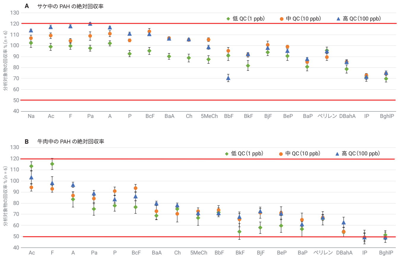
図 4. 最適なサンプル前処理メソッドによるサケ (A) および牛肉 (B) 中の PAH の回収率
