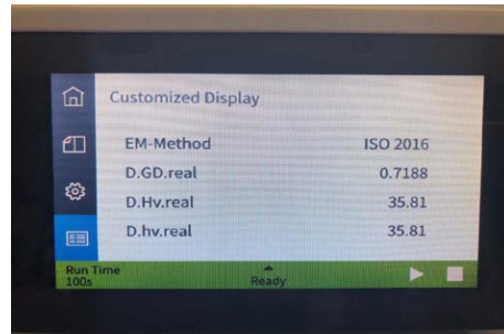
图 5. 显示在 Agilent 990 PRO 微型气相色谱系统触摸屏上的热值计算结果
