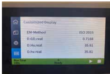
Figura 5. Risultati del calcolo del potere calorifico visualizzati sul touch screen del sistema Micro GC Agilent 990 PRO.
