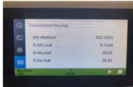
Abbildung 5. Auf dem Touchscreen des Agilent 990 PRO Micro GC dargestellte Ergebnisse zur Berechnung des Heizwerts.
