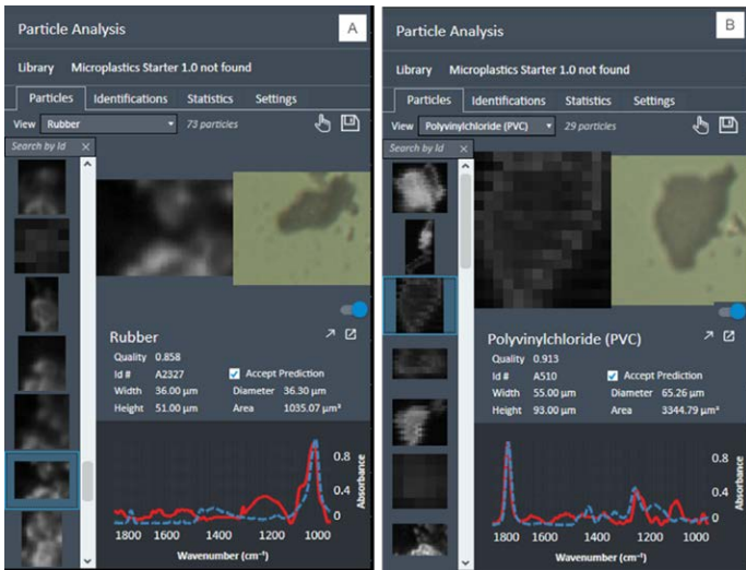
그림 5. 지표수의 고무(A)와 처리된 폐수의 PVC 입자(B)의 식별 결과.
