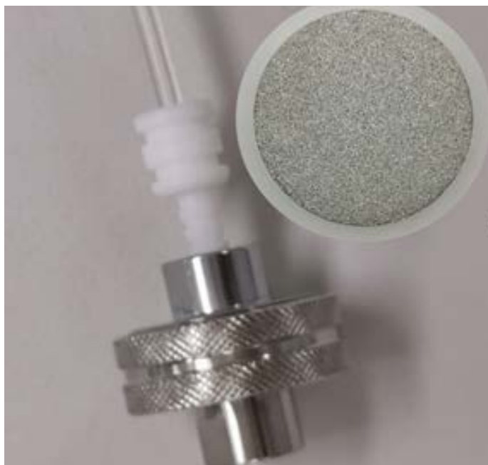
그림 2. 미세 플라스틱 입자 수집에 사용되는 pre-prep 필터 디스크.
