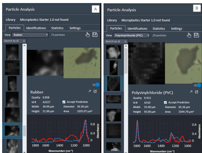
図 5. 表流水中のラバー粒子 (A) と処理済み放流水中の PVC 粒子 (B) の同定結果
