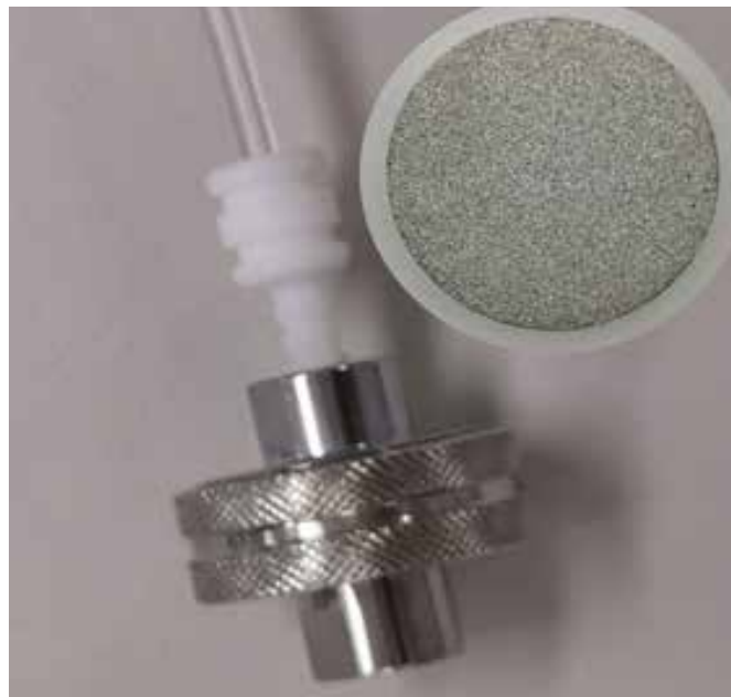
図 2. マイクロプラスチック粒子の採取に使用した分取フィルタディスク
