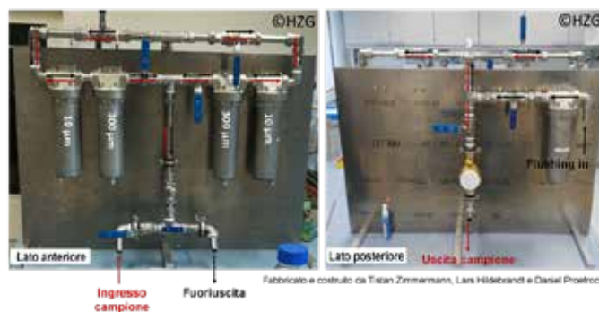
Figura 2. Parti anteriore e posteriore del frazionatore di microplastiche inerti Geesthacht (GIMPF).
