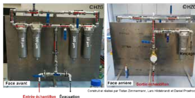
Figure 2. Faces avant et arrière du fractionnateur de microplastique inerte de Geesthacht (GIMPF).
