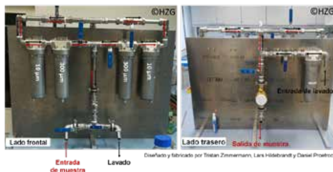
Figura 2. Partes delantera y trasera del fraccionador de microplásticos inerte Geesthacht (GIMPF).
