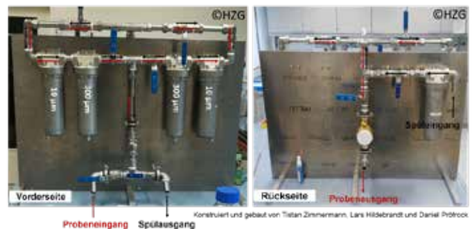
Abbildung 2: Vorder- und Rückseite des Geesthacht Inert Microplastic Fractionator (GIMPF).
