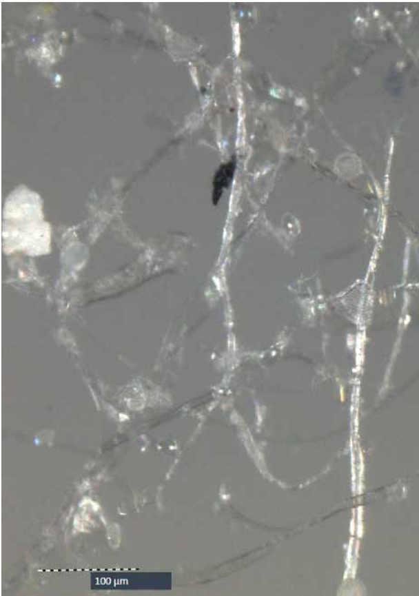
Abbildung 10: Bild eines Aggregats von Cellulosefasern und natürlichen Partikeln, die mithilfe des LDIR aufgenommen wurden.
