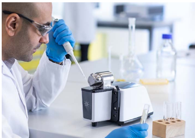
图 2. 将液体样品置于 Agilent Cary 630 FTIR 配备的 DialPath 模块的样品观测窗片上
