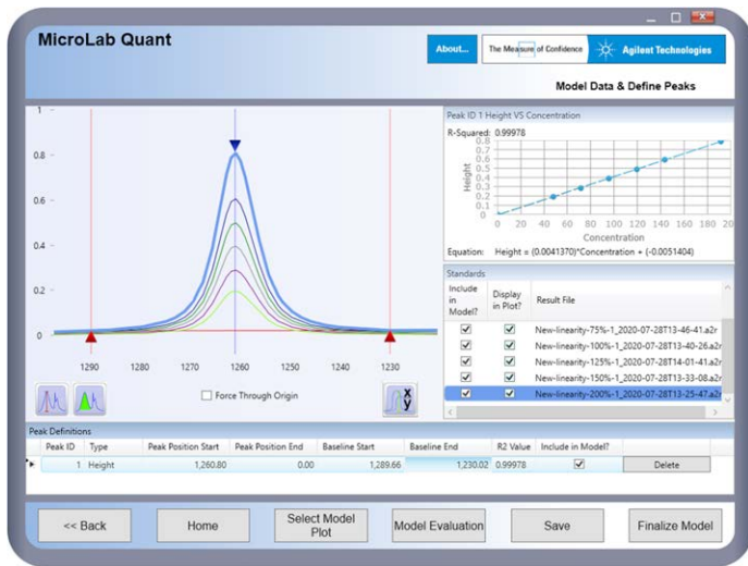
图 5. 使用 MicroLab Quant 软件对 DialPath 进行线性评估。在软件中自动执行校准曲线和相关系数计算。用户可报告获得的结果以实现记录的目的
