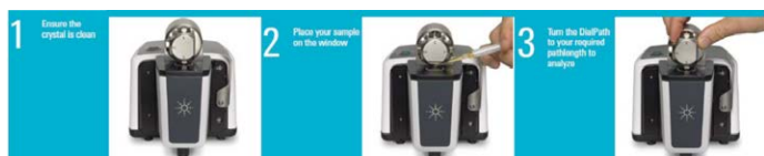
图 1. 使用配备 DialPath 模块的 Agilent Cary 630 FTIR 光谱仪分析液体样品，只需三个简单步骤
