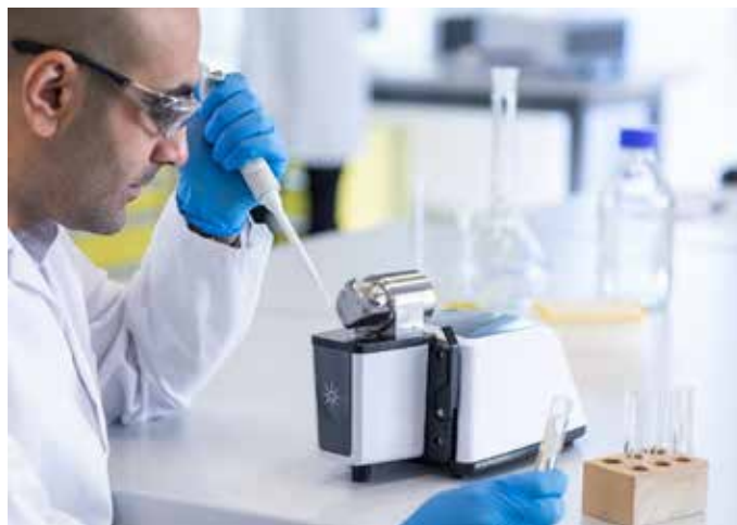
Figura 2. A amostra de líquido é colocada na janela de amostra do módulo DialPath instalado no espectrômetro FTIR Agilent Cary 630.
