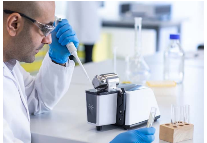
그림 2. Agilent Cary 630 FTIR 분광기에 장착된 DialPath 모듈의 시료 윈도우에 액체 시료를 놓습니다.
