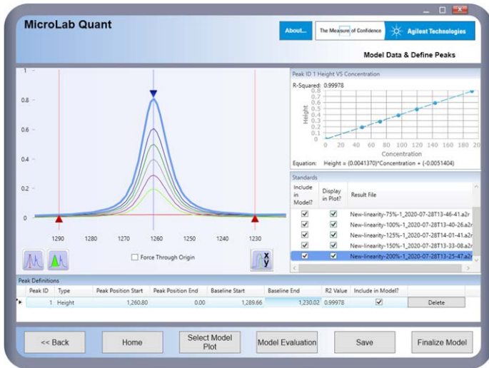
그림 5. MicroLab Quant 소프트웨어를 사용한 DialPath의 선형성 평가. 검량선 및 상관 계수 계산은 소프트웨어에서 자동으로 수행됩니다. 획득한 결과는 문서화 목적으로 보고할 수 있습니다.
