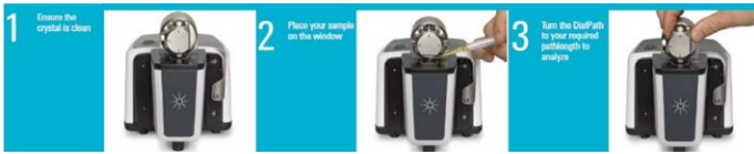
그림 1. DialPath 모듈이 장착된 Agilent Cary 630 FTIR 분광기를 사용하면 간단한 세 단계만 거쳐 액체 시료를 분석할 수 있습니다.
