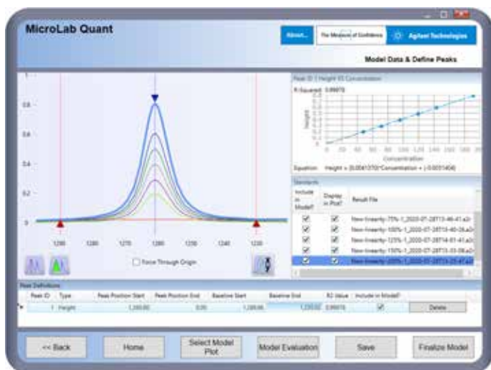
Figura 5. Valutazione della linearità del modulo DialPath con il software MicroLab Quant. Il software calcola automaticamente curve di calibrazione e coefficienti di correlazione. Gli utenti possono referentare i risultati ottenuti a fini di documentazione.
