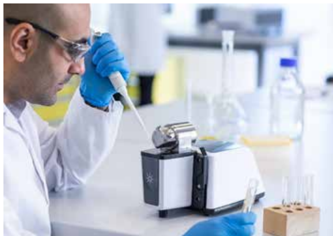
Figura 2. Il campione in soluzione viene collocato sulla finestrella del campione del modulo DialPath installato sullo spettrometro FTIR Agilent Cary 630.
