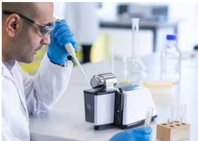
Figura 2. La muestra líquida se colocó en la ventana de muestras del módulo DialPath acoplado al espectrómetro FTIR Agilent Cary 630.
