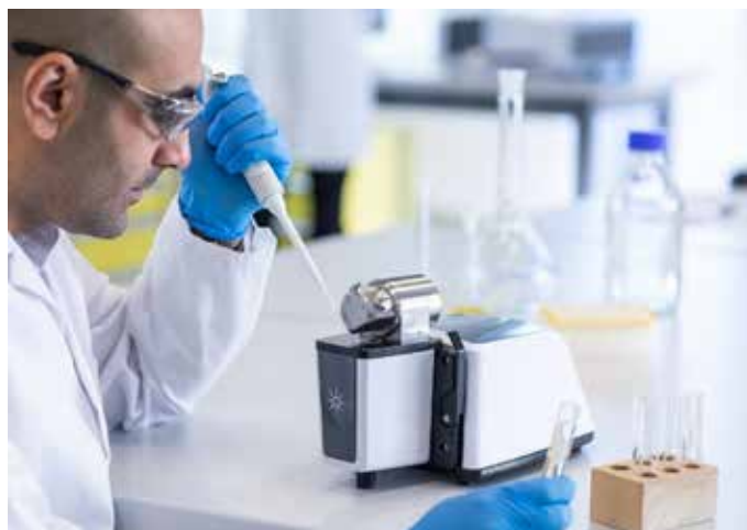
Abbildung 2: Die flüssige Probe wird auf das Probenfenster des DialPath-Moduls, das an einem Agilent Cary 630 FTIR-Spektrometer angebracht ist, aufgegeben.
