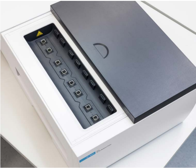
图 1. Cary 3500 多区控温紫外-可见分光光度计的样品室内置有多池支架。每个样品/参比对可以保持在不同的温度
