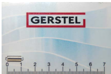
图 1. Twister PDMS 搅拌棒，长 1 cm，萃取相厚度 1 mm
