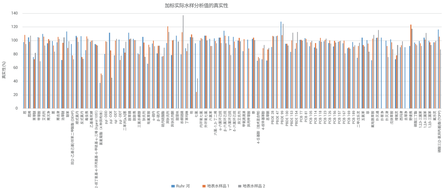
图 11. 以中等浓度加标（每种分析物单独加标）的三个不同实际水样分析值的真实性。在干净的地下水中配制校准样品。如果某种化合物在相应的水样中具有一定的背景浓度，则从加标样品的分析值中扣除该背景浓度。这可能导致实验分析值的真实性较低，例如对于 4-壬基酚、4-叔辛基苯酚或三(2-氯异丙基)磷酸酯 (TCPP)。如果背景浓度接近或甚至超过加标浓度，则省略相应水样的值（图中缺少相应的数据条）
