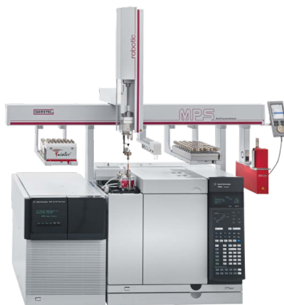
图 3. 用于本应用的分析系统包括: GERSTEL® 多功能进样器 (MPS 自动化系统)、热脱附单元 (TDU 2)、冷进样系统 (CIS 4) 以及 Agilent® Technologies 7890 GC 与 7010 三重四极杆 MS 联用系统
