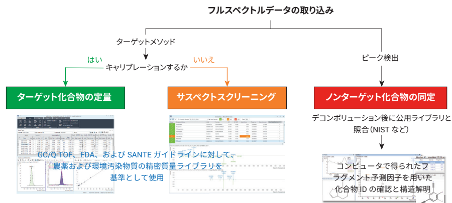
図 2. GC/Q-TOF PCDL を用いたターゲットおよびサスペクトスクリーニングと NIST ライブラリを用いたノンターゲットスクリーニング、およびその後の未知化合物の構造解明する包括的な汚染物質のスクリーニングワークフロー
