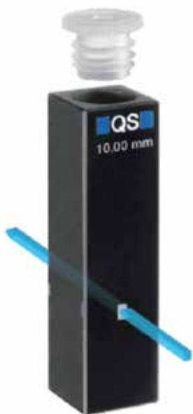
Figure 1. Le spectrophotomètre UV-Vis Cary 3500 possède un faisceau hautement collimaté d'une largeur inférieure à 1,5 mm. La faible taille du faisceau convient parfaitement aux cuves ayant une petite ouverture, comme celle qui est présentée ici.
