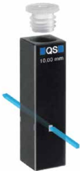
Abbildung 1: Das Cary 3500 UV-Vis-Spektralphotometer hat einen stark gebündelten Strahl, dessen Breite weniger als 1,5 mm beträgt. Aufgrund seiner kleinen Größe ist der Strahl optimal für Küvetten mit kleiner Apertur, wie sie hier gezeigt wird, geeignet.
