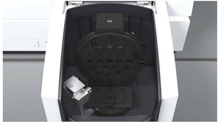
그림 1a. 고체 자동 시료 주입기가 설치된 Cary 7000 UMS 측정 챔버의 평면도.
