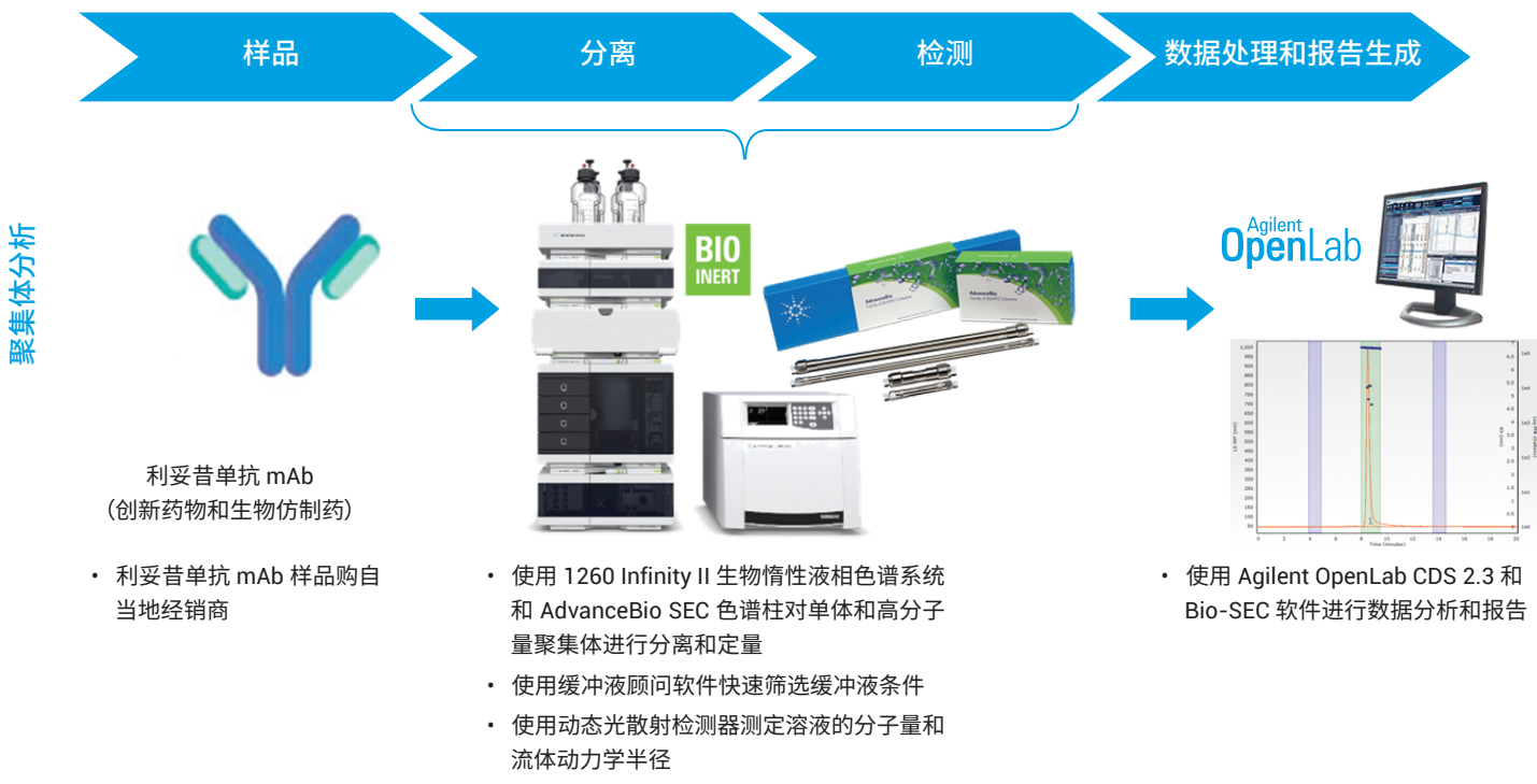
图 1. 用于分析利妥昔单抗创新药物和生物仿制药的电荷异构体和聚集体分析工作流程
