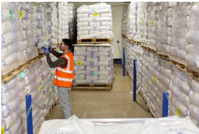
Figura 1. Uso del espectrómetro portátil de Raman Agilent Vaya para medir los materiales que se encuentran en sacos en un almacén de cuarentena.
