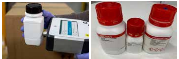
Figura 4. Análisis de las materias primas a través de un contenedor de polietileno blanco mediante el instrumento Vaya y ejemplos de los contenedores en los que se recibieron las materias primas (tampones biológicos).
