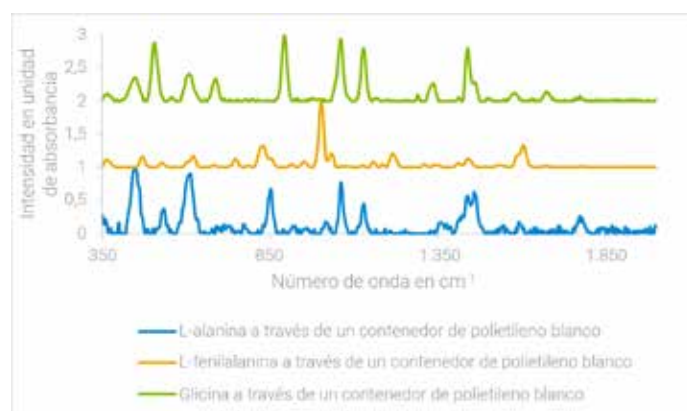
Figura 7. Espectro Raman superpuesto de los aminoácidos, obtenido directamente a través de cada uno de los contenedores.
