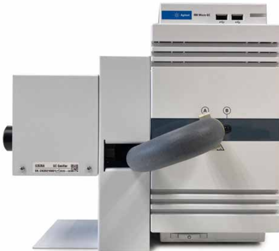
Figura 1. Il gassificatore per GC Agilent G3535A installato sul sistema Micro GC Agilent 990.
