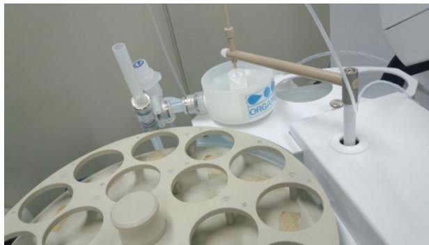
图 1. 安装在安捷伦 I-AS 自动进样器上的 Organo 流动清洗口组件
