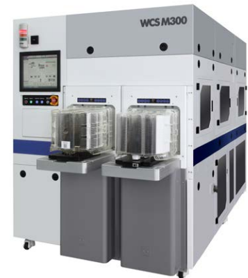
图 5. 韩国 NvisANA 的 WCS M300 自动化 VPD 扫描仪系统
