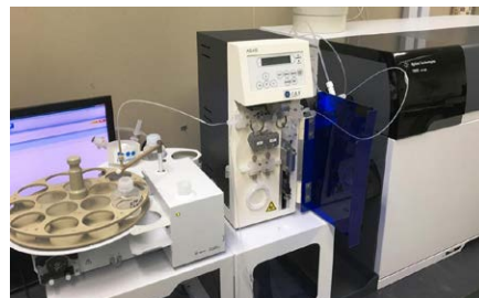
图 12. ASAS 自动化标准加入设备，日本 IAS Inc. 的 CSI 在线监测系统的一部分
