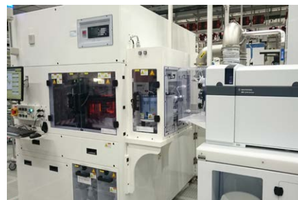
图 7. 与 Agilent 8800 ICP-MS/MS 集成的由 IAS Inc. 制造的全自动 VPD-ICP-MS 系统 Expert PS。图片由法国克罗勒的 ST Microelectronics 提供
