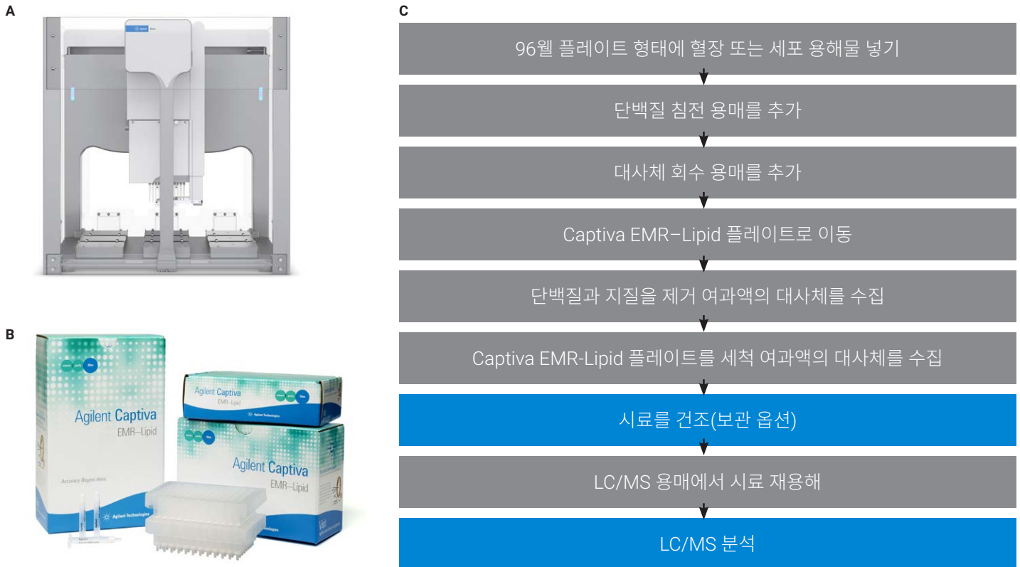
그림 2: 표적 대사체학 연구에서 자동화된 시료 전처리를 위한 애질런트 솔루션입니다. A. Bravo Metabolomics 시료 전처리 플랫폼 B. Captiva EMR-Lipid 고체상 추출 플레이트 C. 일반적인 극성 대사체 추출 프로토콜.
