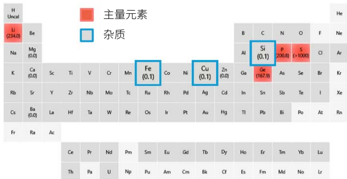
图 3. 含 0.2% LGPS 的 24% 逆王水的 IntelliQuant Screening “热图”，显示了分析元素的半定量浓度。杂质元素已用蓝色标出
