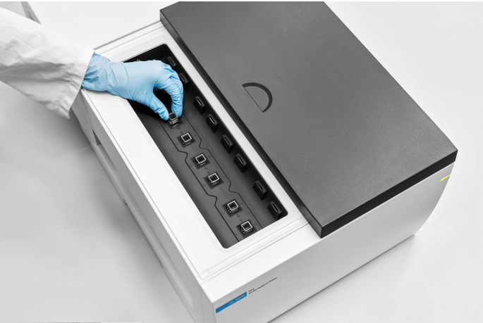
图 1. Agilent Cary 3500 多池紫外-可见分光光度计采用基于光纤技术的双光束光学系统设计，具有八个固定比色皿位置，并配有八个独立检测器，最多可同时测量七个样品和一个参比样品
