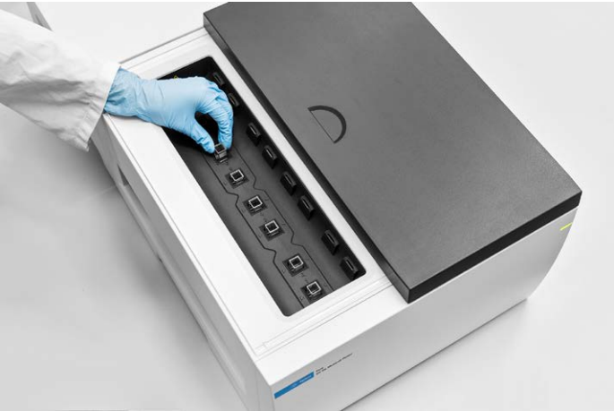
그림 1. Agilent Cary 3500 Multicell UV-Vis 분광 광도계는 8개의 고정 셀 위치와 광섬유 기술을 적용한 이중 빔 광학 설계, 그리고 8개의 개별 검출기를 갖추고 있어 최대 7개의 시료와 표준물질을 동시에 측정할 수 있습니다.
