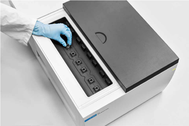
図 1. Agilent Cary 3500 マルチセル UV-Vis 分光光度計は、8 つの固定セル位置と、光ファイバー技術を採用したダブルビーム光学設計、および対応する 8 つの検出器を備えており、最大 7 種類のサンプルと 1 種類の参照標準の同時測定が可能です。
