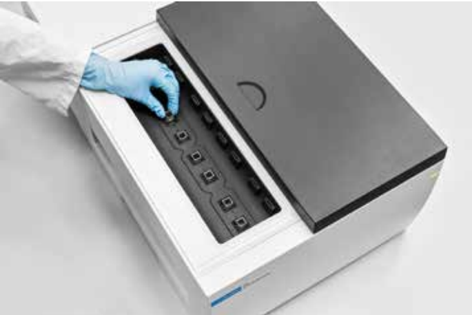
Figura 1. Lo spettrofotometro UV-Vis multicella Cary 3500 di Agilent dispone di otto posizioni fisse per le celle e di un design ottico a doppio raggio con tecnologia a fibre ottiche e otto rispettivi rivelatori, che consentono la misurazione simultanea di un massimo di sette campioni e un riferimento.
