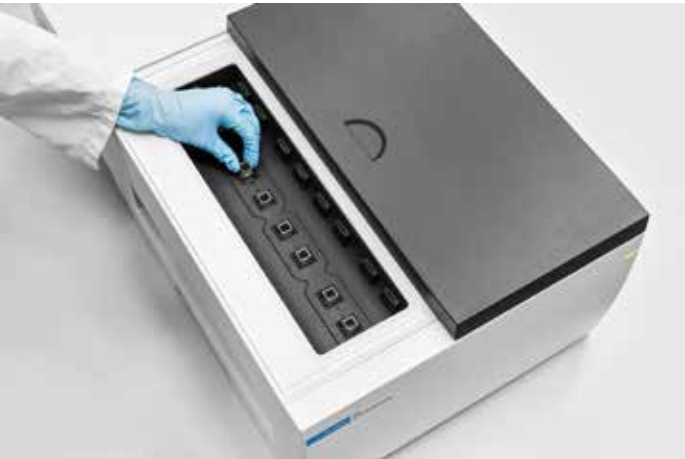
Figure 1. Le spectrophotomètre UV-Vis Agilent Cary 3500 Multicuves dispose de huit positions de cellules fixes ainsi que d’une conception optique à double faisceau avec technologie à fibre optique et huit détecteurs respectifs, permettant de mesurer simultanément jusqu’à sept échantillons et une référence.
