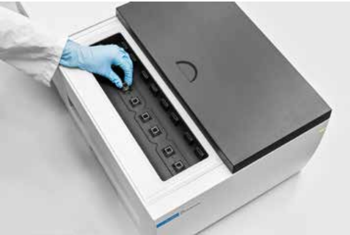
Figura 1. El espectrofotómetro de UV-Vis Agilent Cary 3500 Multicell cuenta con ocho posiciones de celdas fijas y un diseño óptico de doble haz con tecnología de fibra óptica y ocho detectores respectivos, lo que permite el análisis simultáneo de hasta siete muestras y una referencia.
