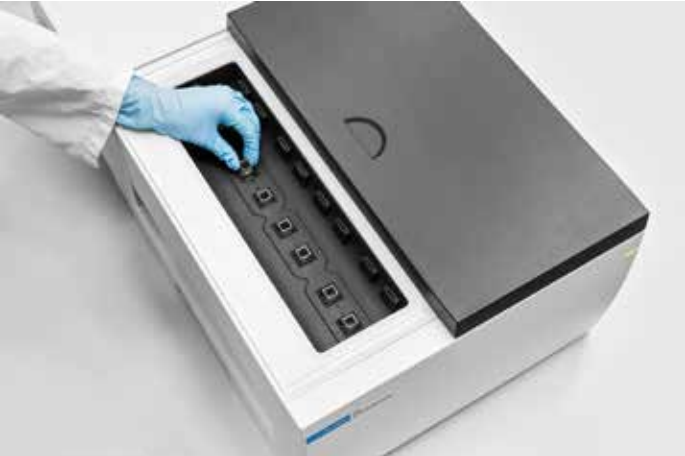
Abbildung 1. Das Agilent Cary 3500 Multiküvetten-UV-Vis-Spektralphotometer verfügt über acht stationäre Zellpositionen und ein optisches Doppelstrahl-Design mit Glasfasertechnologie sowie acht entsprechende Detektoren, was die gleichzeitige Messung von bis zu sieben Proben und einer Referenz ermöglicht.
