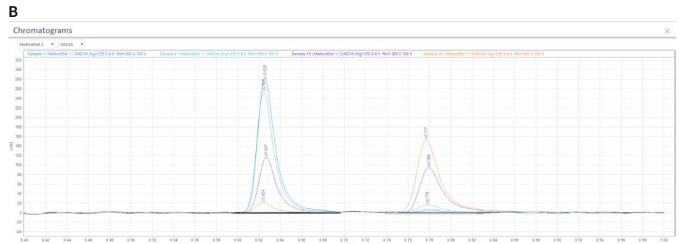
그림 9. 결과 탭에 시각화된 최종 결과. (A) 강조 표시된 반응 데이터 지점의 결과 표에는 머무름 시간, 피크 높이, 면적, 면적 백분율, 농도, 보정된 농도가 나와 있습니다. (B) 0.626분에서 줄어드는 아세틸살리실산 피크 및 0.777분에서 증가하는 살리실산 피크.
