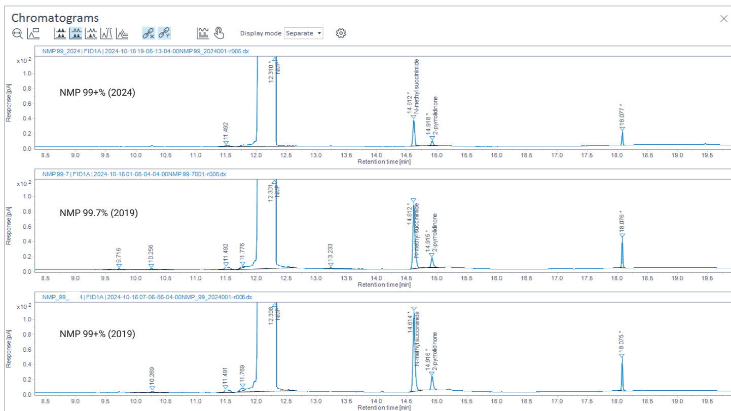
图 3. 使用 Agilent J&W DB-23 色谱柱分析市售溶剂获得的归一化色谱图
