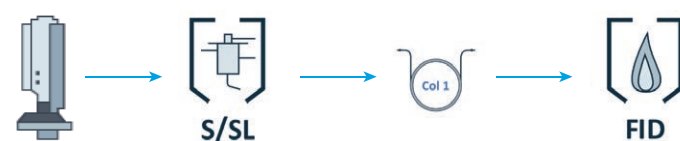
图 2. Agilent 8850 GC 流路
