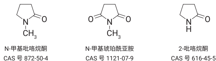
图 1. N-甲基吡咯烷酮 (NMP)、N-甲基琥珀酰亚胺 (NMS) 和 2-吡咯烷酮 (2PYR) 的结构和化学文摘社 (CAS) 编号
